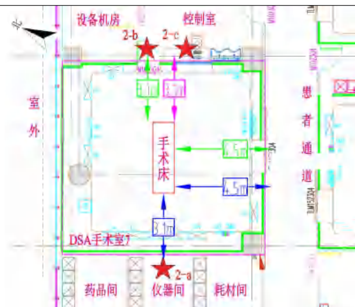
四层介入中心DSA手术室7靶点（患者）距墙体、观察窗、防护门关注点最短距离
