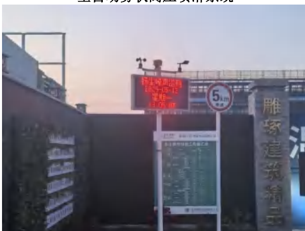
噪声扬尘监测装置
