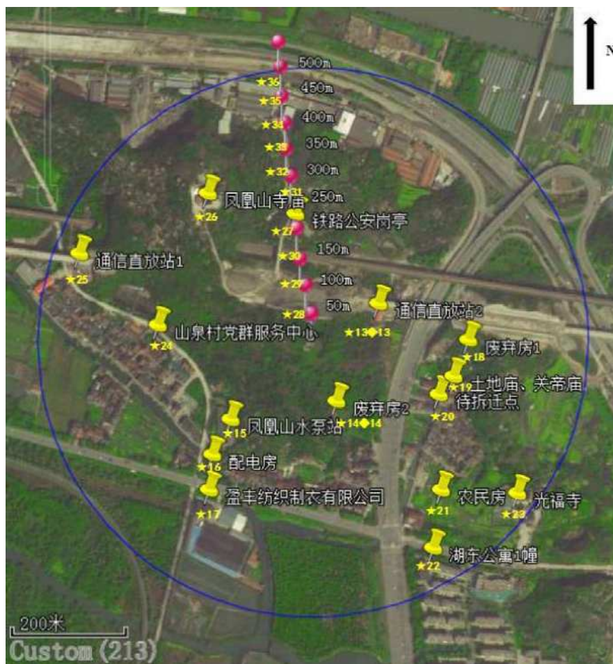
图 3 凤凰山气象监测站建设工程 500 米范围内敏感点与断面射频场强检测点位示意图
