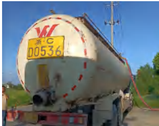
施工期泥浆外运车辆（密闭运输）
