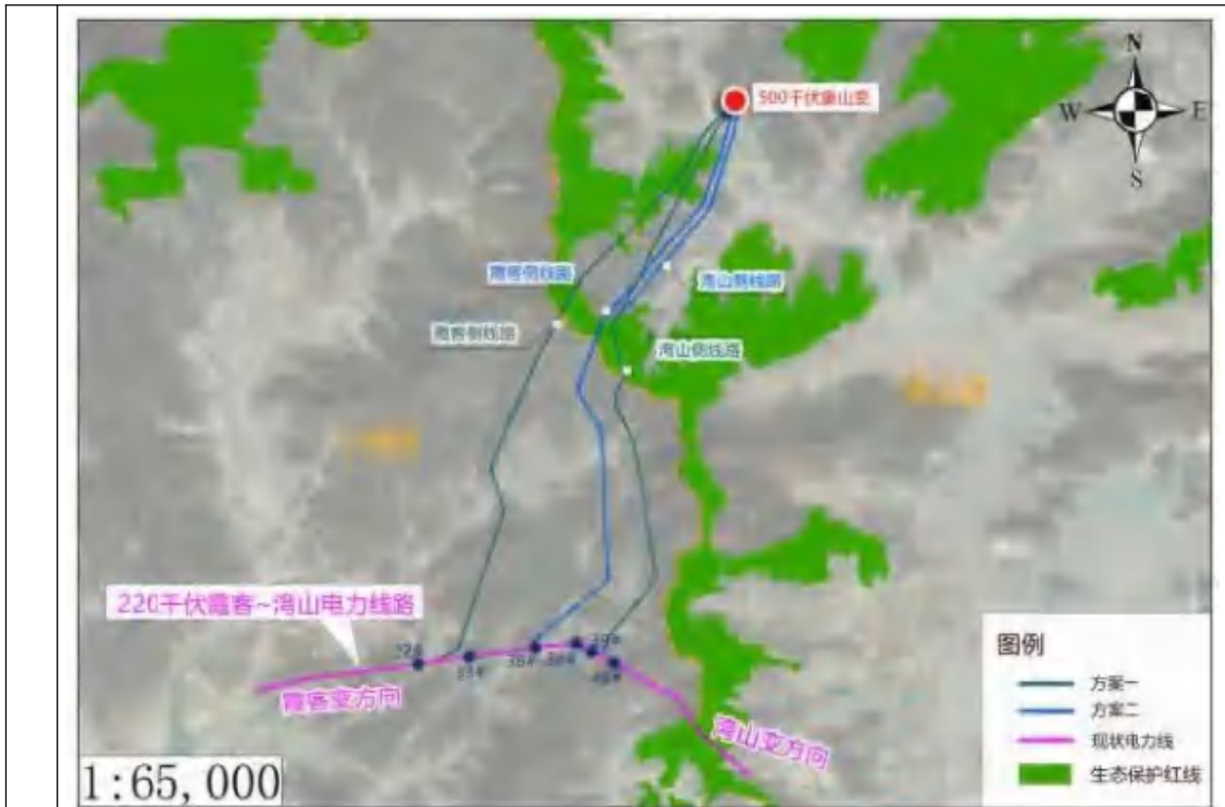
图 4.3-1 霞客~湾山 \pi 接象山变输电线路比选方案示意图
