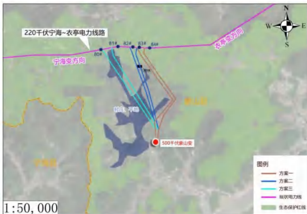
图 4.3-1 宁海~衣亨 \pi 接象山变输电线路比选方案示意图
