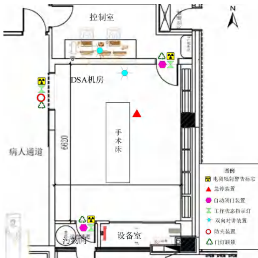
图 10-3 本项目 DSA 机房辐射安全防护措施布置示意图
