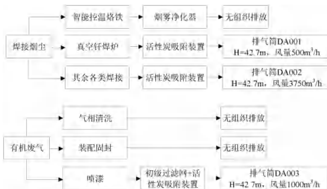
图1 废气收集治理措施汇总图
