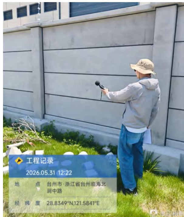
变电站厂界噪声监测
