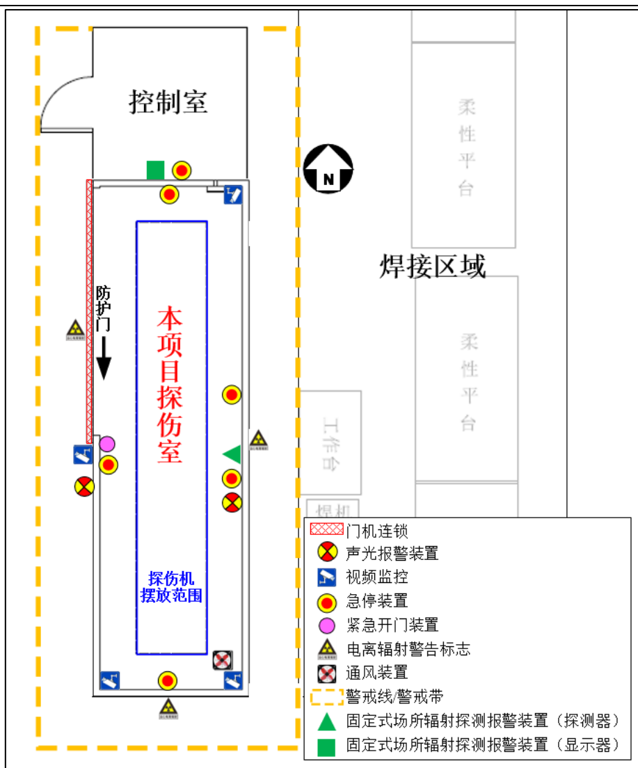
图 10-3 本项目探伤室防护措施位置示意图
