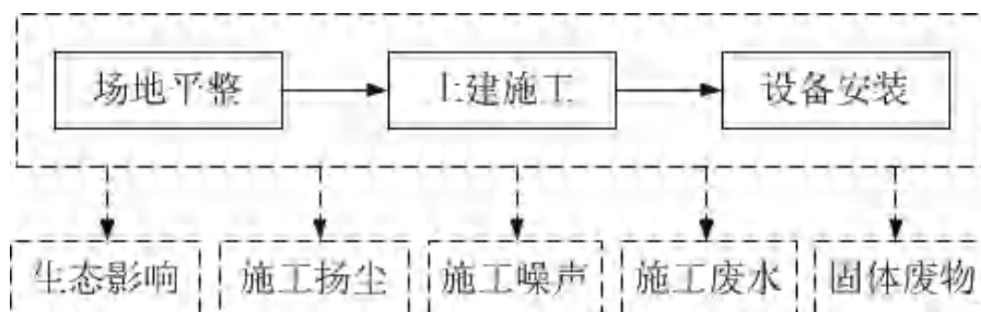
图 4-1 变电站建设期产污环节
