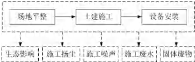
图 4-1 变电站建设期产污环节
