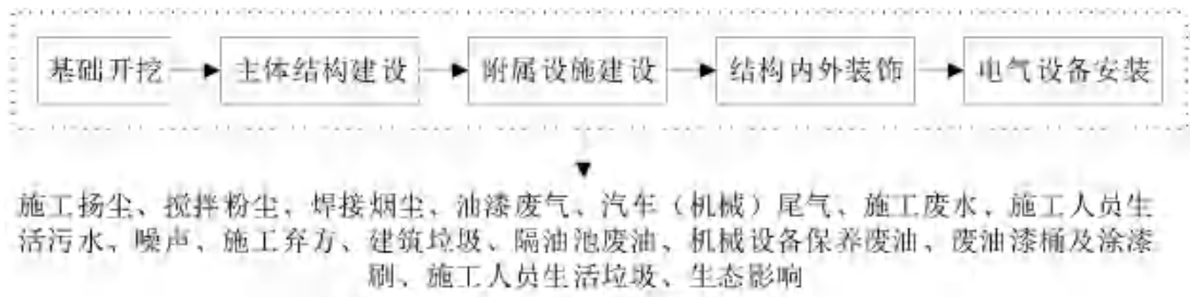
图 2-7 升压站施工工艺流程及产污节点图
